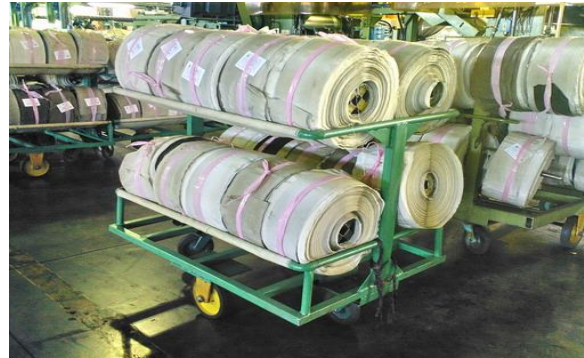
شکل ۵: پالت های اصلاح شده در ایستگاه اسلیتر
